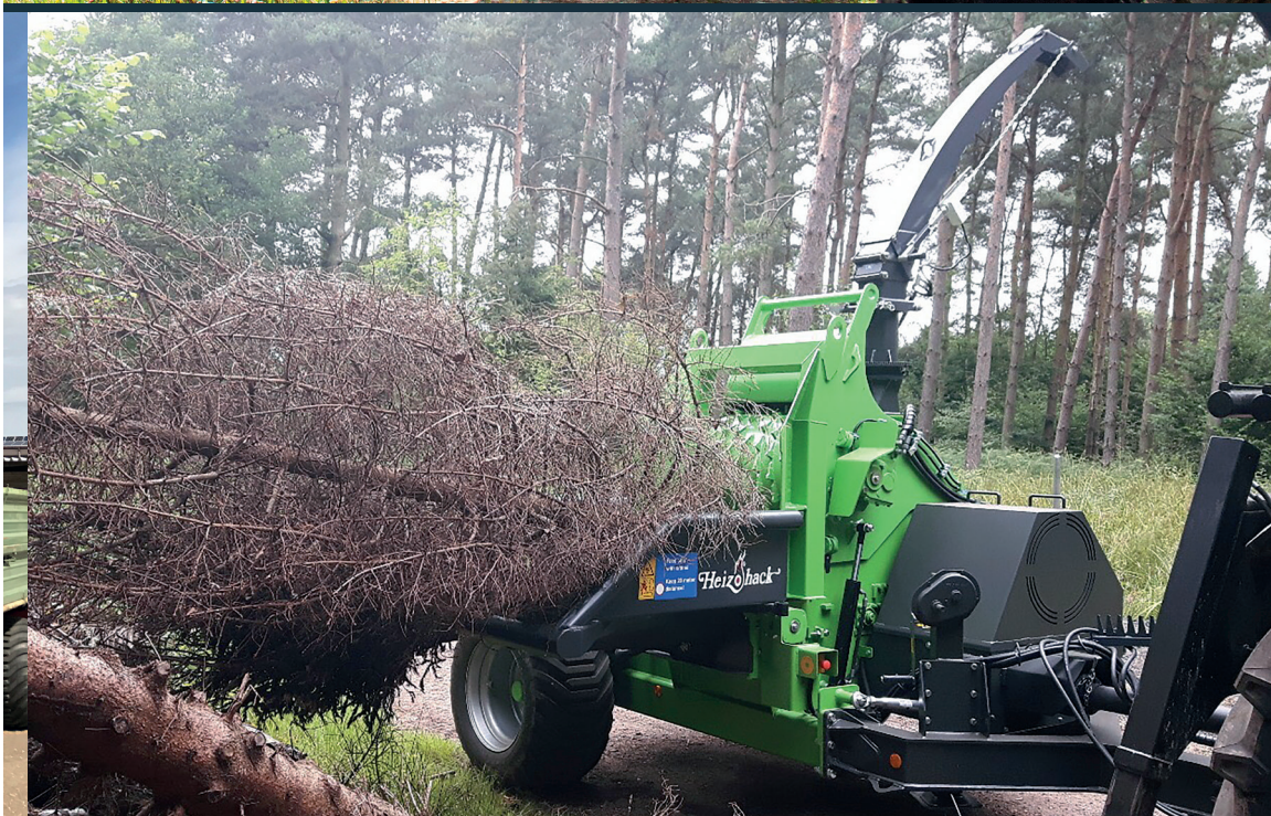
Vetoaisan korkeus säädettävissä 520, 620, 900 ja 1000 mm (*2)
