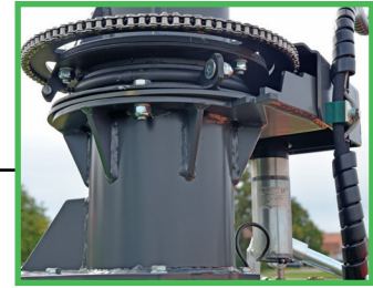
Sähköinen torven kääntö Sähkömoottorilla ja ketjuvedolla
