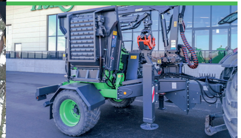
Vetoaisan korkeus säädettävissä 520, 620, 900 ja 1000 mm (*2)
